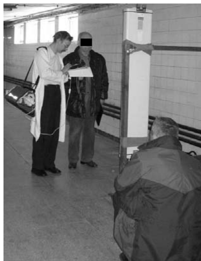
Rys. 3 Realizacja badań interferencji antena stacji bazowej – kardiostymulator metodą in vivo
