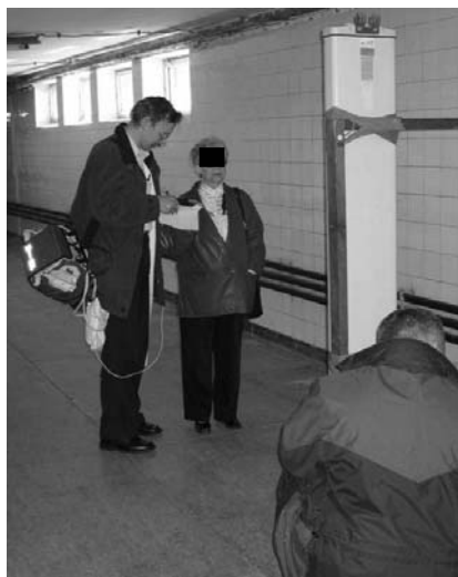
Rys. 3 Realizacja badań interferencji antena stacji bazowej – kardiostymulator metodą in vivo
