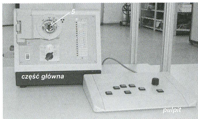
Rys. 2. Stanowisko do wzorcowania i sprawdzania logometrycznych wskaźników samochodowych widok od przodu
