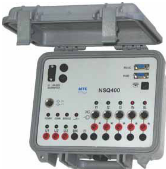
Rys.3. Analizator i rejestrator parametrów sieci energetycznej NSQ400. Fig. 3. Power quality parameters analyzer and recorder type NSQ400.
