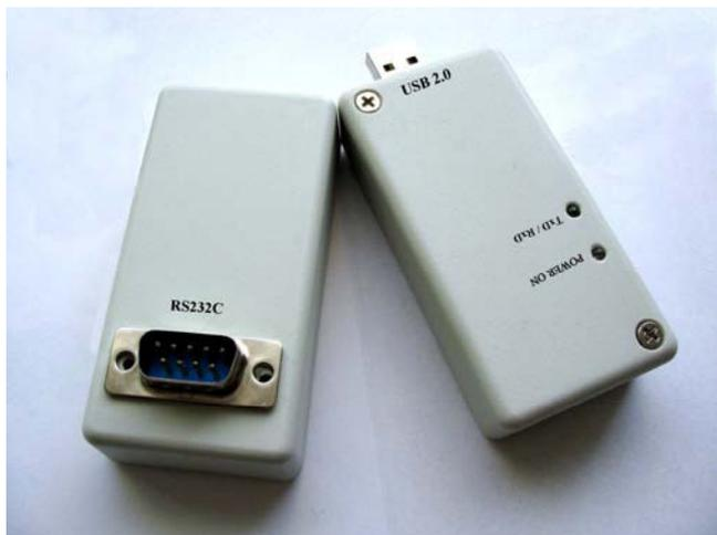
Rys.3. Konwerter Bluetooth na RS232C i konwerter USB na Bluetooth
