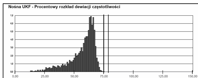
Rys. 1 Prezentacja graficzna wyniku pomiaru dewiacji częstotliwości (wynik pozytywny)
