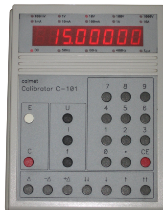
Rys.2. Pulpit sterujący kalibratora C101. Fig.2. External control keyboard of calibrator C101.
