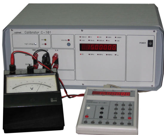
Rys.1. Układ pomiarowy do wzorcowania lub sprawdzania mierników. Fig.1. The measurement system for adjusting and checking a meter
