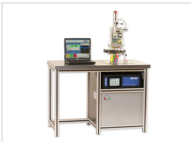
Rys. 4. Widok stacjonarnej jedno-stanowiskowej stacji wzorcowniczej typu LS3 Fig. 4. View of the LS3 Stationary Single Position Meter Test Bench
