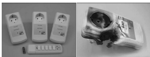
Rys. 3. Gniazdo elektryczne sterowana radiowo, uległo zapłonowi w trakcie badań prowadzonych przez laboratorium BNetzA w Kolbergu.
