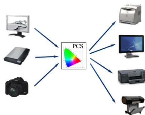
Rys. 1. Schemat ideowy otwartego systemu zarządzania barwą Fig. 1. Open color management system
