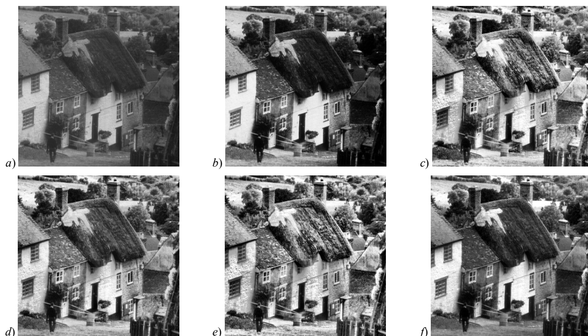
Rys. 2. Powiększony fragment obrazów będących w wyniku przekształcenia obrazu GOLDHILL (a) metodą: b) GHE, c) CLAHE dla \alpha=1 , d) CLAHE dla \alpha=0,01 , e) GWCE-HE, f) GWCE-HS dla \alpha=0,0025 (objaśnienia skrótów w tekście)
